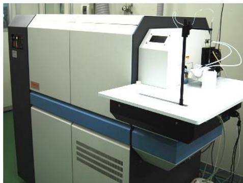
高分解能型ICP質量分析装置
