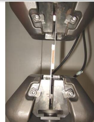
せん断剥離強度試験測定例
