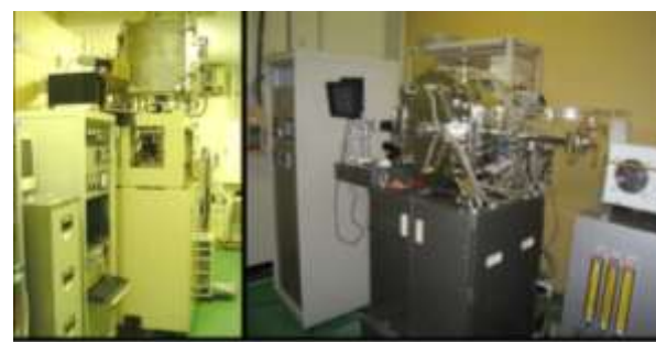
写真5(弗化物単結晶育成マイクロ引き下げ装置/吉川研)
